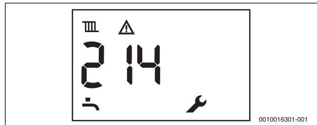
Rys. 68 Przykład: usterka niepowodująca blokady
